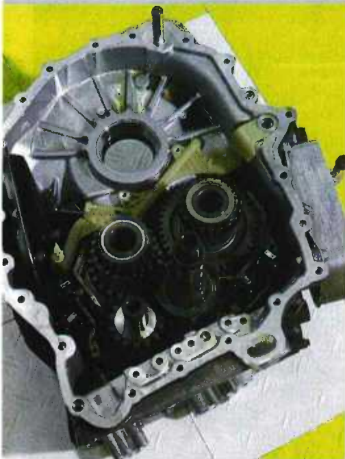
De DSG is gebaseerd op de bekende en betrouwbare 3-assige 02M-bak van Volkswagen.
