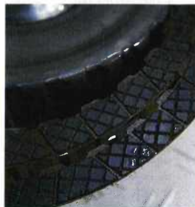
Versleten (boven) en goede koppelingenplaten. Veelvuldig schakelen onder zware belasting, bijvoorbeeld het rijden met een caravan in de bergen waarbij de bak constant aan het open- en terugschakelen is, vraagt veel van de koppelingenplaten met als gevolg extreme warmte-ontwikkeling en dus slijtage. U herkent ze aan de kleur waarbij de lichtere (boven) zijn versleten.
