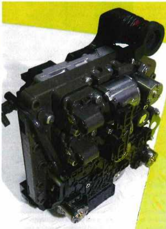
Het onderdeel dat volgens Ronald relatief vaak sneuvelt is de Mechatronic. In dit huis zijn de sensoren, kleppen en regelunit ondergebracht. Repareren blijkt meestal niet mogelijk, vervangen is de enige optie.
